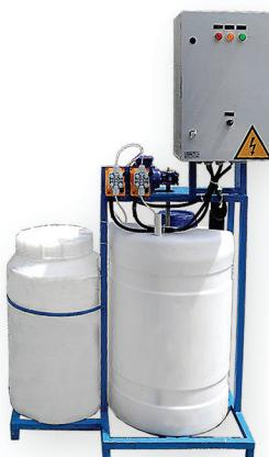
شركة ابرام، مصممة ومصنعة لأنواع مختلفة من حزمات الحقن الكيميائي مثل الكلور، الاخماس و القلوبيات والمواد مختارة، وما إلى ذلك ، في مختلف القدرات لمختلف الاستخدامات بما في ذلك الاستخدام في محطة معالجة المياه العادمة، مصافي التكرير و مجمعات البتروكيماويات، صناعة المواد الغذائية وأكثر من ذلك
