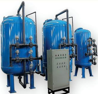
یکی از محصولات شرکت آبرام پکیج فیلتر شنی و فیلتر کربنی می باشد. این پکیج یک سازه پیش ساخته برای کاهش کدورت و ذرات معلق آب (TSS) است . فیلتراسیون شنی یکی از مراحل تصفیه آب چهت شفاف سازی آب می باشد. معمولا از مخازن فولادی و FRP برای بستر فیلتر های شنی استفاده می شود. این مخازن به شکل استوانه و دایره ای ساخته می شود در دستگاه فیلتر شنی، آب دارای کدورت بالا از بستر دارای سیلیس دانه بندی شده عبور داده می شود و مواد کلوئیدی و معلق در لای سیلیس گیر کرده و آب را شفاف می نماید.
