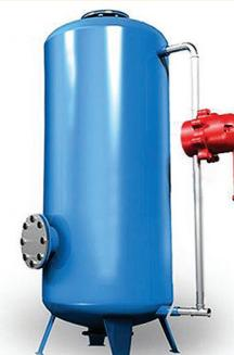
پکیج سختن گیر آب محصول شرکت آبرام، یک سازه پیش ساخته است برای کاهش سختن آب روش کار دستگاه سختن گیر بر اساس تبادل یونی (Ion Exchange) است. در این روش از رزین های تبادل یونی یا همان رزین های سختن گیر استفاده می شود. این سازه پیش ساخته به صورت طراحی شده است که داخل آن رزین تبادل یونی قرار می گیرد و آب با فشار از داخل آن عبور می نماید آب پس از عبور از داخل فیلتر باعث می شود که آب سخت تبدیل به آب نرم گردد. آب نرم عموما در صنایع چهت جلوگیری از کاهش عمر دیگر های بخار کاربرد دارد.
